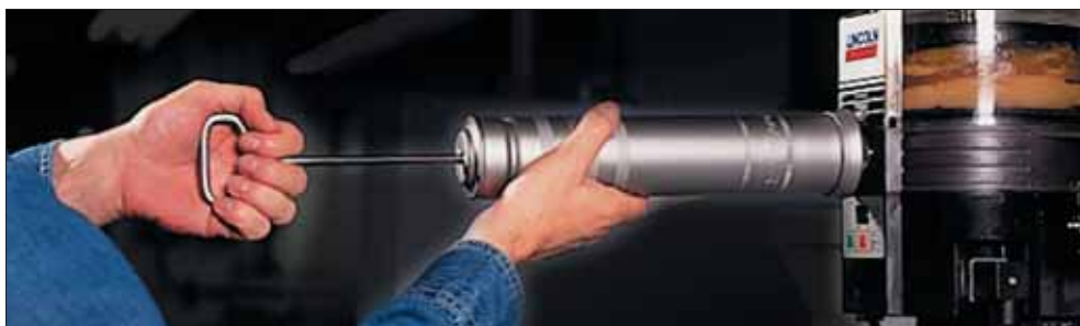
Наполнение насосов Quicklub: быстро и просто
